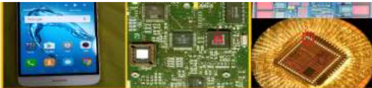
图4 手机 图5 电路板：黑块为集成电路 图6 集成块内部的芯片和连线
