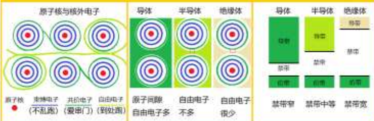
图13 原子核与电子 图14 导体 半导体 绝缘体 图15 能带图
