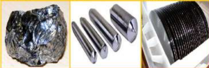
图10 硅材料 图11 硅棒 图12 硅片（晶圆）
