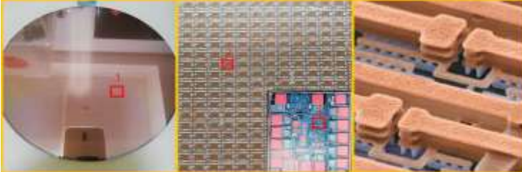
图7 硅片晶圆 图8 芯片 图9 芯片内部连线
